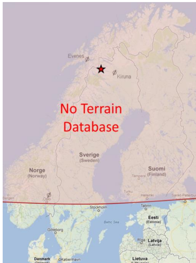
Fig. 10. Kartbild över Skandinavien. I det rödmarkerade området har TAWS i läge Tactical ingen terrängvarningsfunktion. Haveriplatsen är markerad med en röd stjärna. (Kartbild från Google Maps.)
