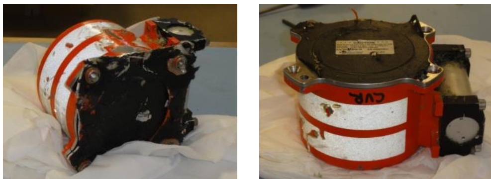
Fig. 23-24. De kraschskyddade minnesenheterna från DFDR och CVR. (Bild SHK.)
