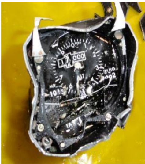
Fig. 35. Reservinstrument för höjd och fart. (Foto: SHK.)
