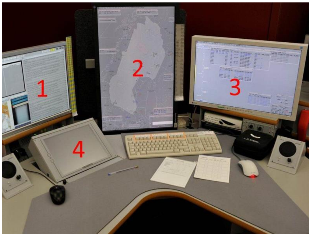
Fig. 15. E-positionen för Z-behörighet på Stockholm ACC. Omedelbart vid sidan utanför bild finns den identiska P-positionen. Siffrorna markerar följande utrustning: 1=väderinformation, 2=radarskärm, 3=planeringsverktyg för ankommande trafik, 4=VCS (radiopanel).
