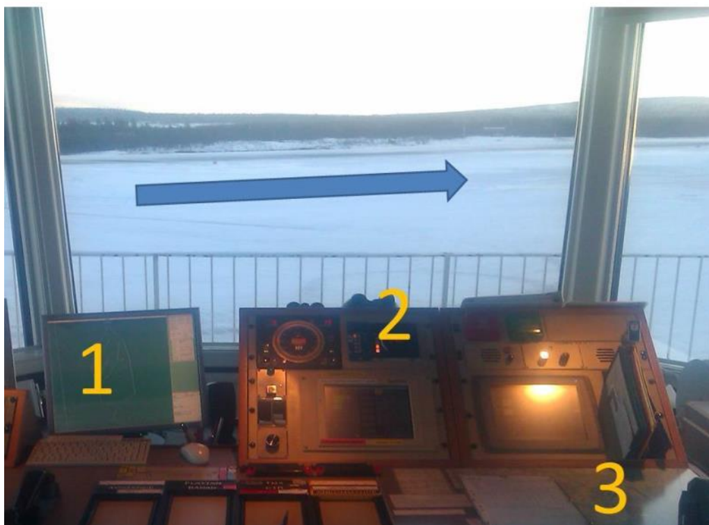
Fig. 18. Flygledarens arbetsposition i Kirunatornet. Siffrorna markerar följande utrustning: 1=radarskärm, 2=pejl, 3=karta. Den horisontella pilen markerar banas placering, vars riktning är 03/21. Kebnekaise fanns vid tidpunkten för händelsen inte utmärkt på radarskärmen.
