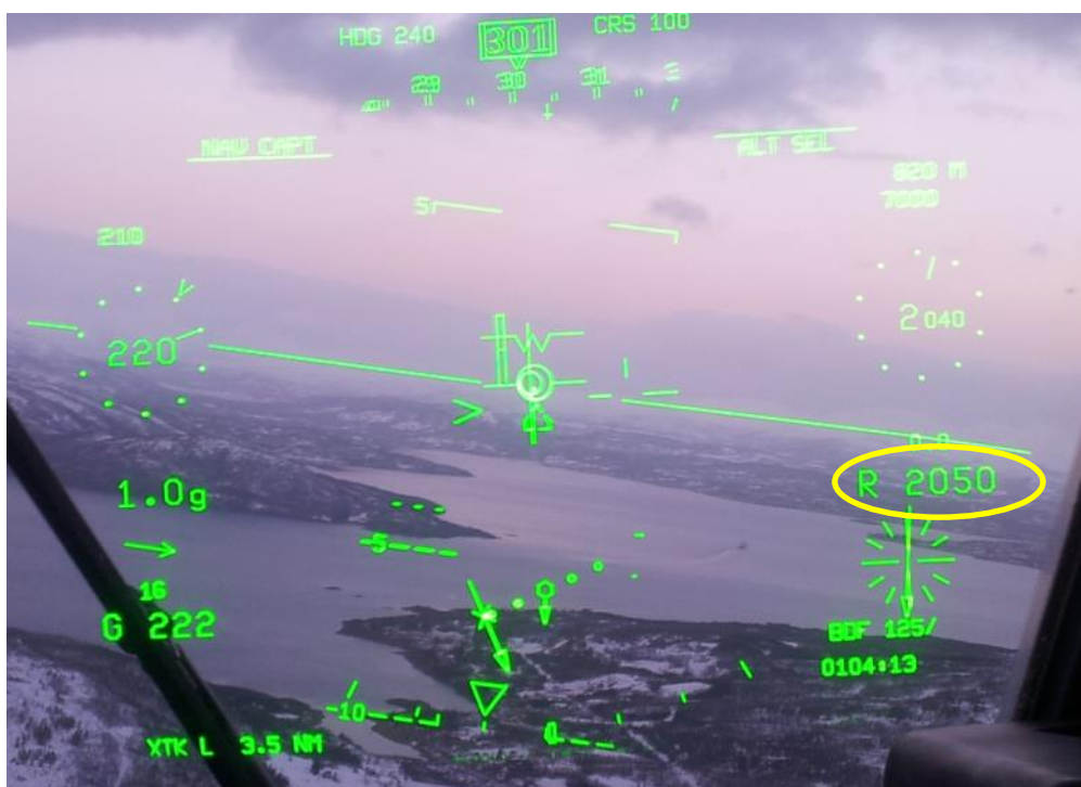
Fig. 9. Bild på Head Up Display, HUD, med aktuell radarhöjd inringat med gult. (Bild: norska Luftforsvaret.)
