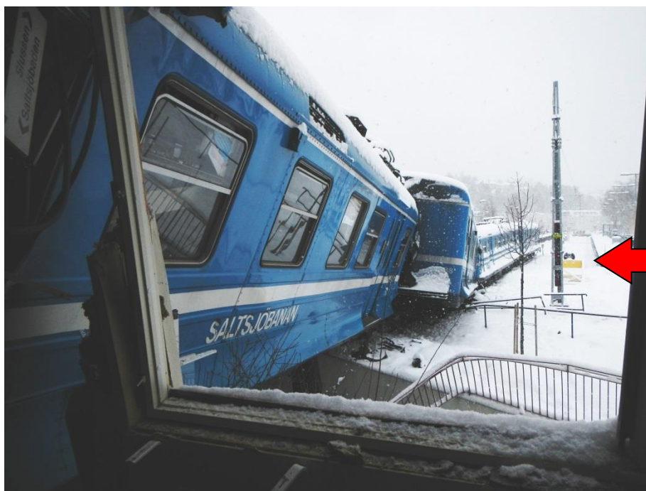
Figur 3. Fordonsättet gick in 5-7 meter i lägenheten på plan 1. Pilen visar stoppbockens placering på spår 2. Stoppbocken på spår 1 stod i jämnhöjd med denna.
