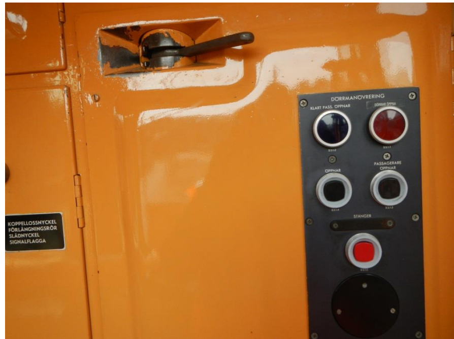
Figur 5. I slutet av städningen kontrollerar städerskan vanligtvis att passagerardörrarna stänger som de ska genom att trycka på en centralstängningsknapp inne i förarhytten.
