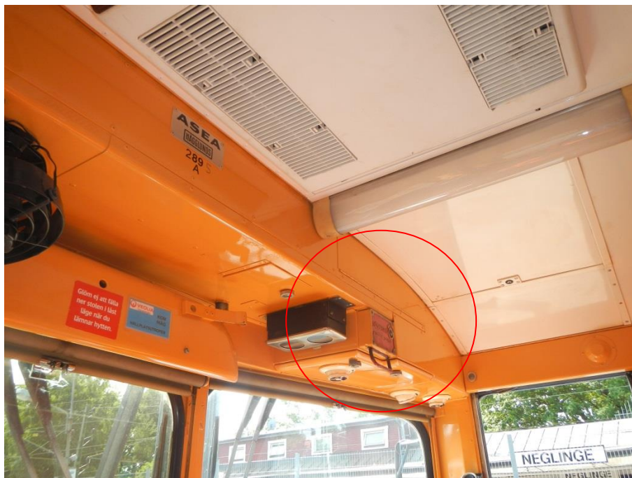
Figur 6. Placering av nödbroms i förarhytt.
