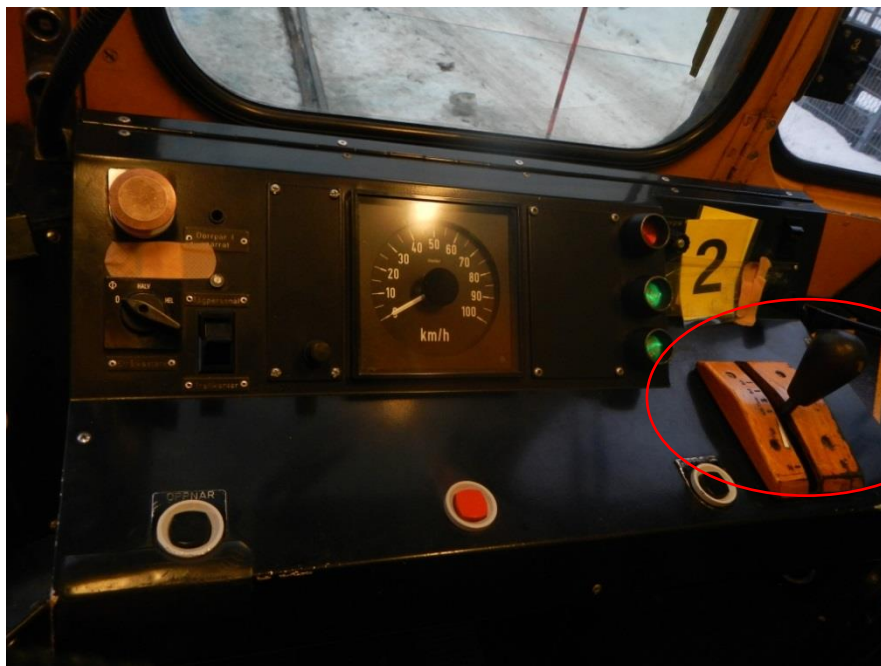
Figur 11. Mitre delen av förarens manöverplats. Till höger i bild (inringad med en röd cirkel) syns körspaken.
